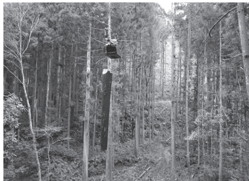
ラジキヤリー(自走式搬器)による集材状況(千早赤阪村東阪地区)
