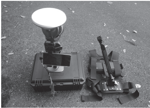
地上レーザー計測の実施状況(右)と使用機械(Lixel L2Pro)
