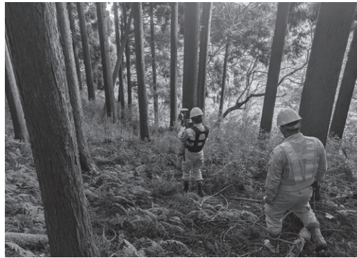
地上レーザー計測の実施状況(右)と使用機械(Lixel L2Pro)
